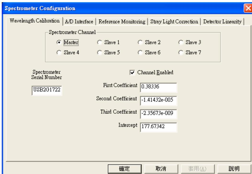
如果以上程序都正確的話 USB serial number 和 Spectrometer serial number 是一樣的。使用光譜儀之前要先確認當沒有入射光時光譜的計數值是否在 0 的位置，若不是，請檢查 "correct for elect dark" 是否打勾。
