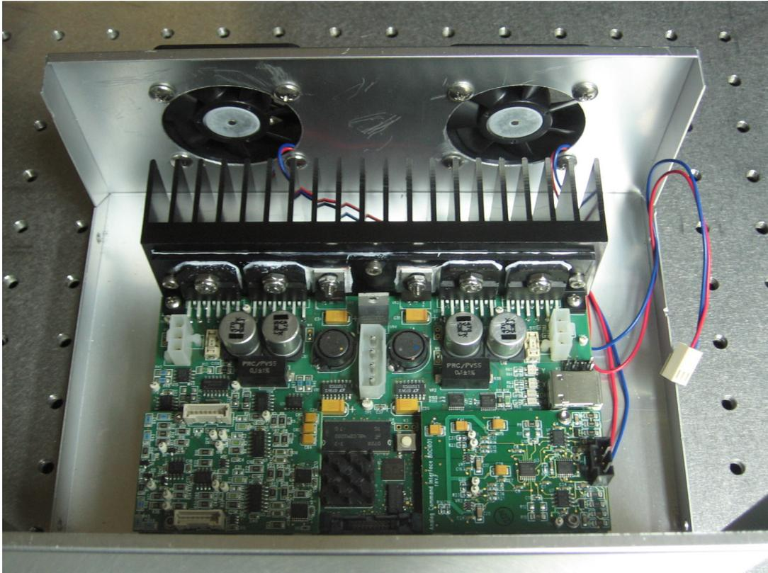
裝上散熱片後的 PositionPro-2 servo board
