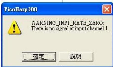
6. 前方有提到，因為實驗室目前使用的 SPAD 是 TTL mode，輸出訊號為正，必須透過 Router 轉換為 PicoHarp 300 接收的負訊號，或是使用 SIA 300 反轉及衰減器。
